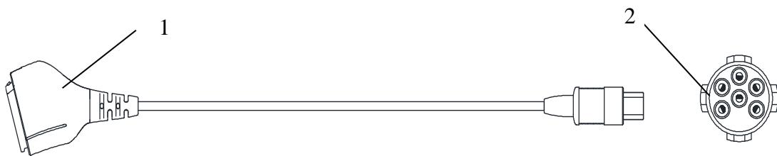
1 信号处理单元接头; 2 体佩式电池仓接头
