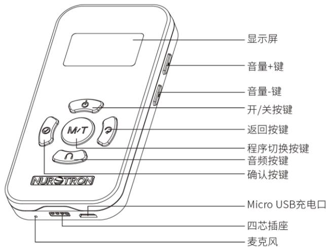
图 5 遥控器外观结构图
