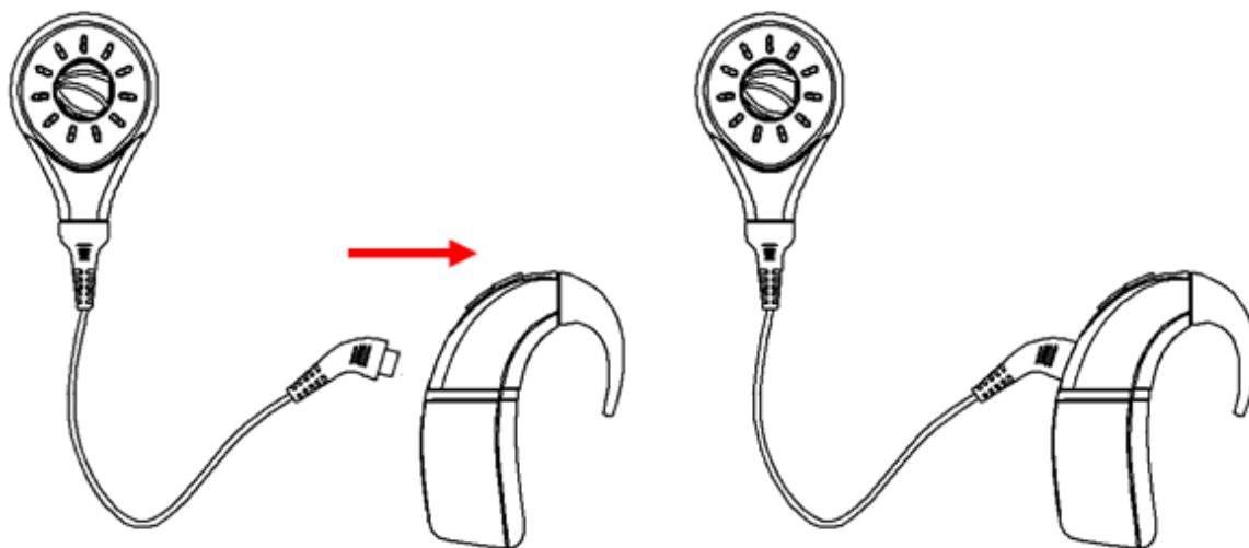
图 14 传输导线与信号处理单元的连接
