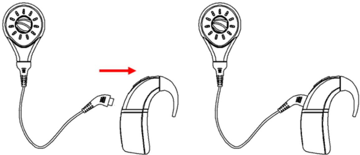
图 17 传输导线与信号处理单元的连接
