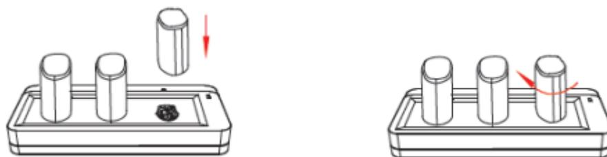
图 17 耳背式充电电池与充电座的连接
