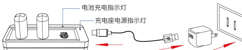
图 18 耳背式充电电池充电示意图
