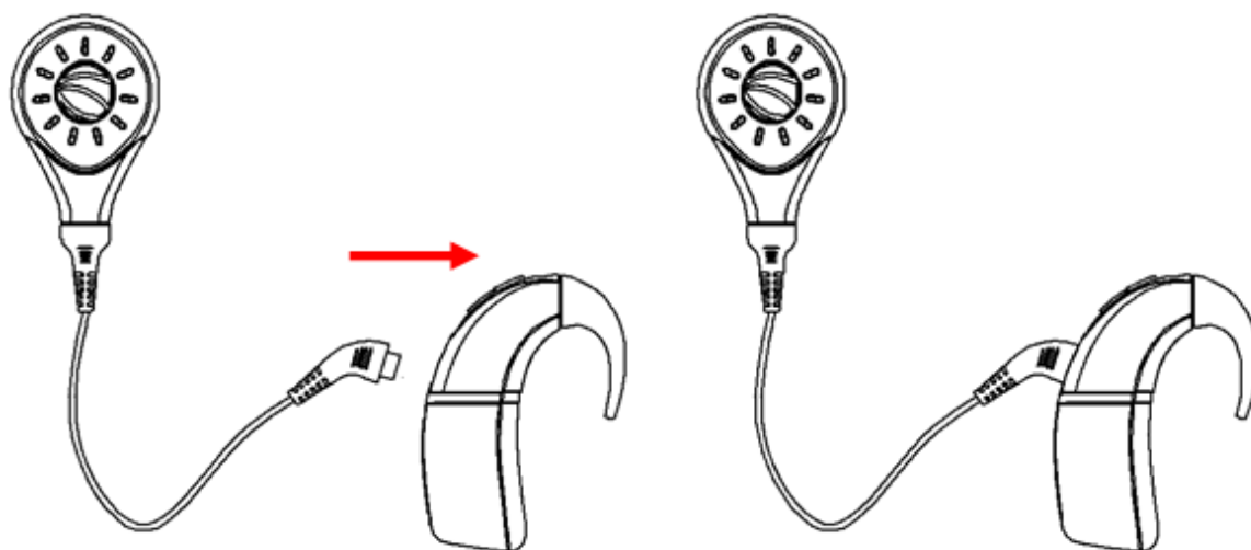
图 32 传输导线与信号处理单元的连接
