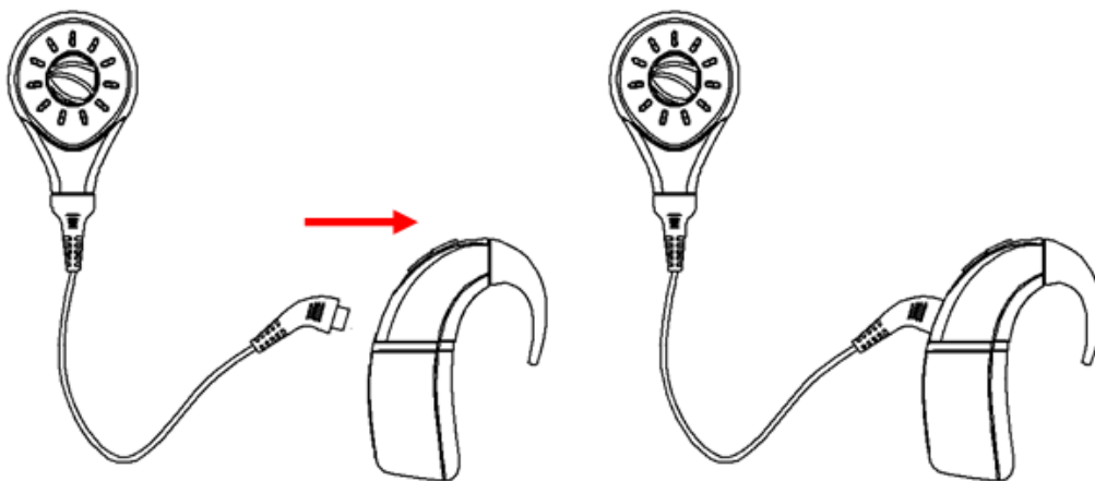
图3：传输导线与信号处理单元的连接
